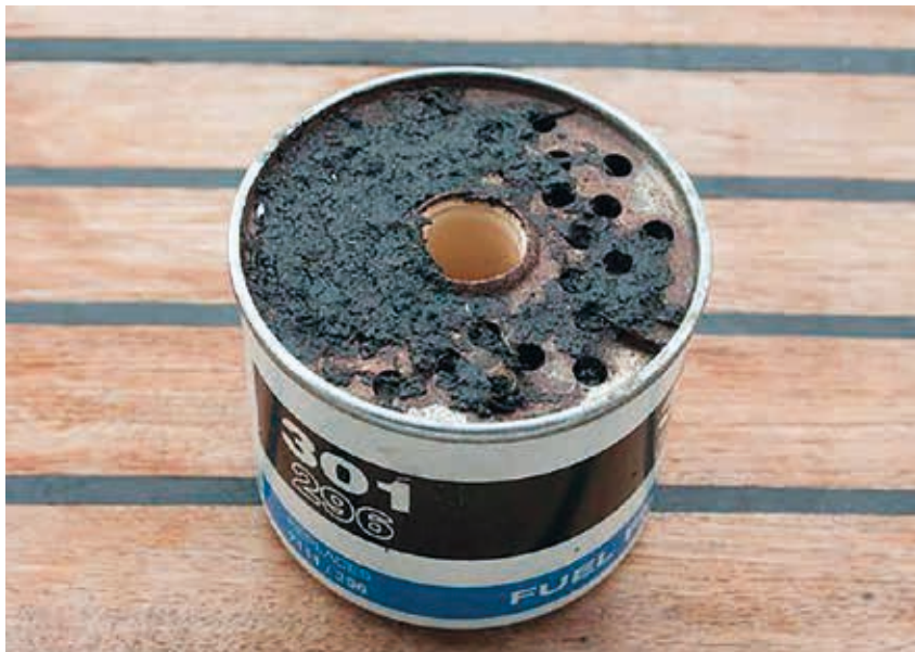
Diesellevän tukkima PA-suodatin. Yäk! Ja matka tyssää siihen (kuvalähde: Iltalehti).
